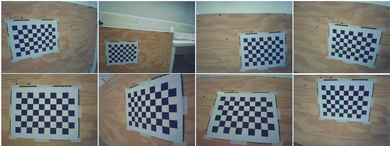
Figura 4.7: Subconjunto de imágenes obtenidas por el **VANT** para realizar la calibración de cámara mediante el algoritmo de Zhang *et al.* en [70]
