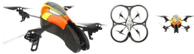
Figura 1.7: Cuadricóptero *AR.Drone*, **VANT** tipo **VTOL**.
