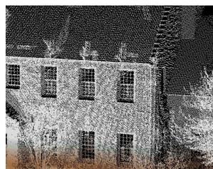
(c) Modelo por escáner láser, nube de puntos densa
